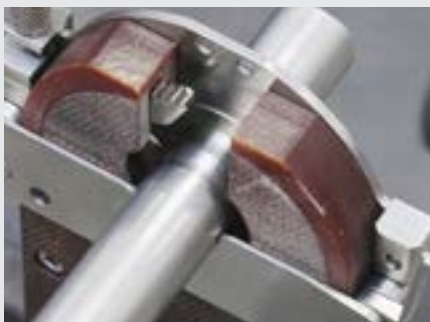
/ Hochwertige Schweißergebnisse durch geschlossene Schutzgaskammer
